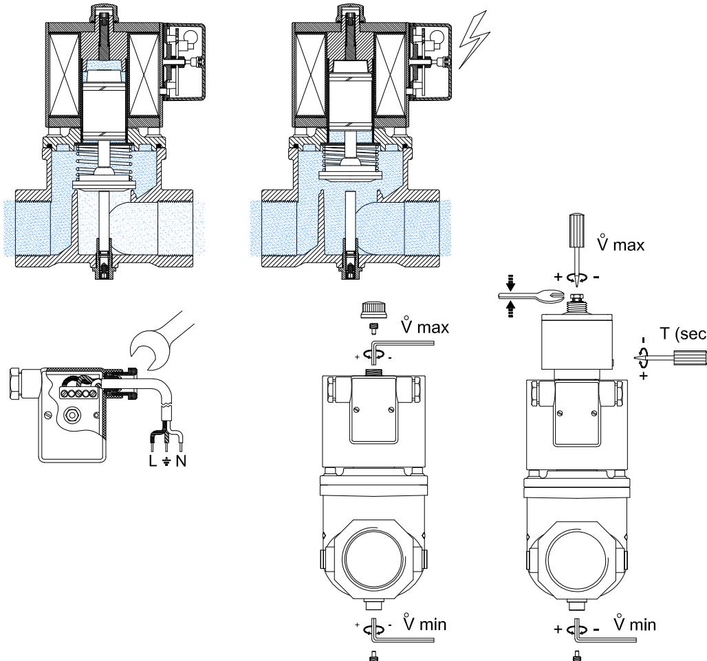
SOLENOID VALVE FOR COMBUSTION AIR
